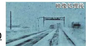
映像鮮明化技術により車載モニターで周辺状況を確認
