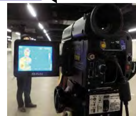
検温設備(サーモグラフィ)
