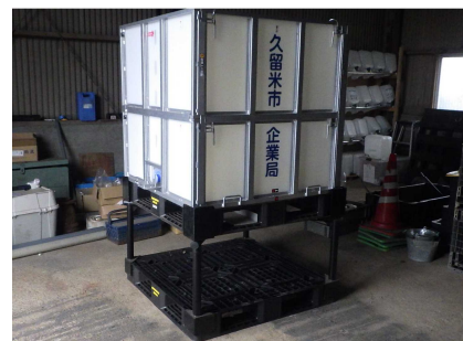
組立式給水タンク(1,000リットル)
