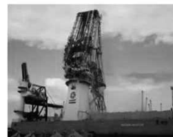
重量物吊り上げにより生じたクレーン倒壊事故 (SAFETY4SEA HP)
