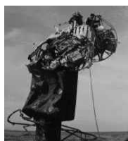
損傷した浮体式灯標
