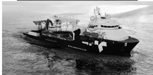
作業船の例(ケーブル敷設船)
