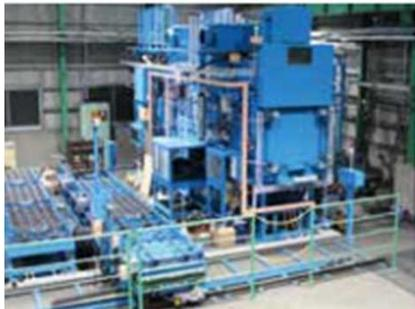
生産性の高い設備の導入を積極的に行っている(ガス軟窒化炉)
