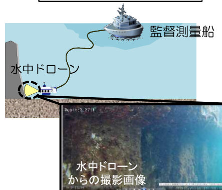
漁港施設の水中心検の効率化事例
