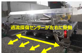
従来の鋼床版下面からの点検に加えて、 舗装上面からもき裂を特定できる 非破壊検査装置を適用（2016(H28)年～）
