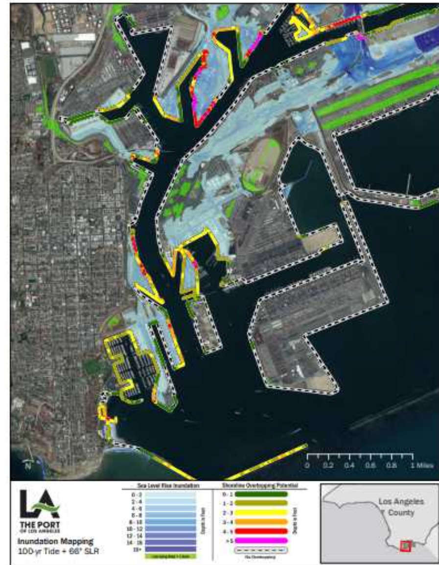
岸壁越水とヤード浸水进行评估
