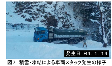
図7 積雪・凍結による車両スタック発生の様子
