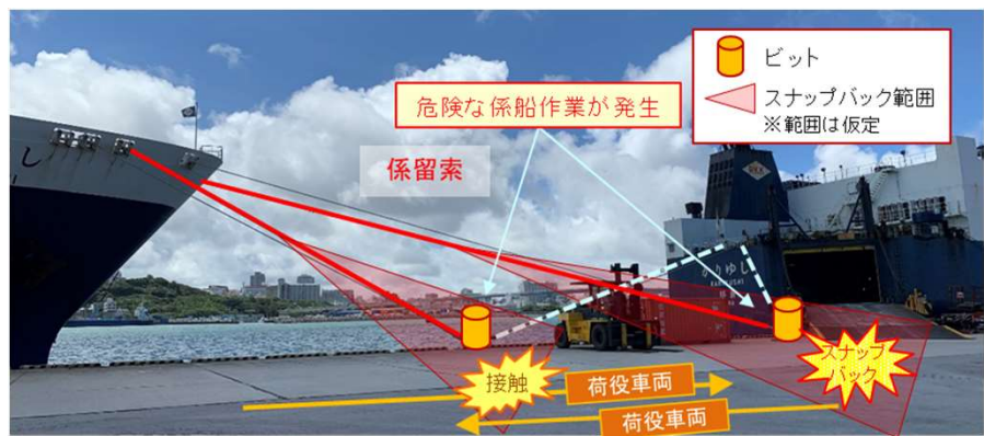
那覇港におけるクロスビット、同一ビット係留の危険性
