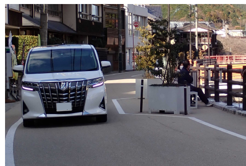
狭窄部による速度抑制（左岸道路）
