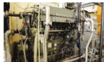
ガスエンジン試験設備
