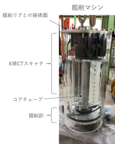
a) 掘削装置
