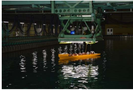
図 1.2.18 船体構造デジタルツインの波浪中実験
