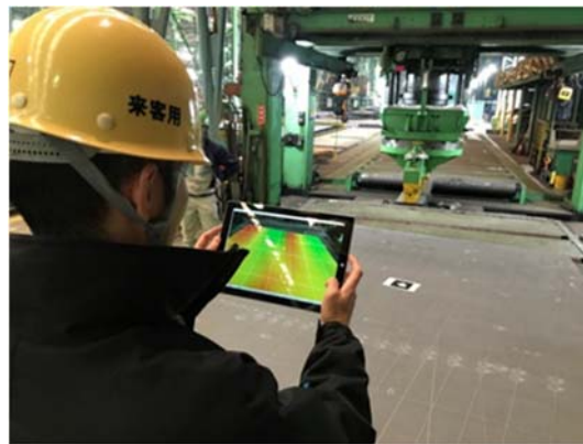
図 1.2.136 実際の造船所における「曲げ加工支援 AR システム」の検証
