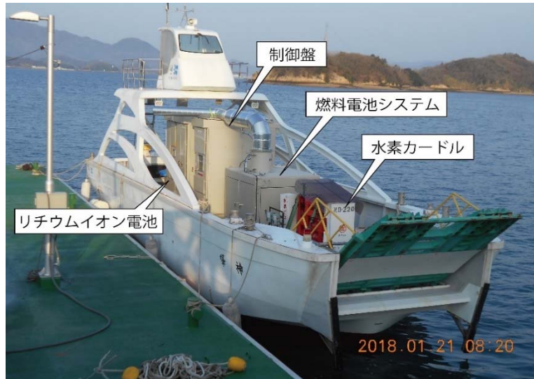
図 1.2.52 水素燃料電池システムおよびリチウムイオン電池を搭載した小型実験船
