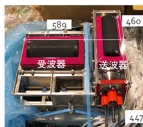
気中重量：92 kg 耐水圧：3000m 深海用
