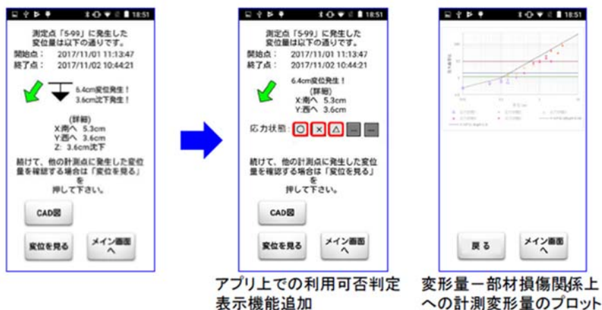
図 1.3.A7 岸壁使用可否判断支援システム「Berth Surveyor」における表示機能の強化
