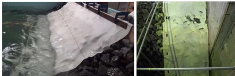
図 1.3.A102 防砂シートの耐久性の実験
