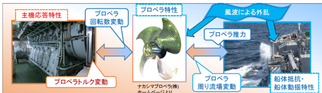
図 1.2.80 船体抵抗+プロペラ+主機応答連成プログラムの概要
