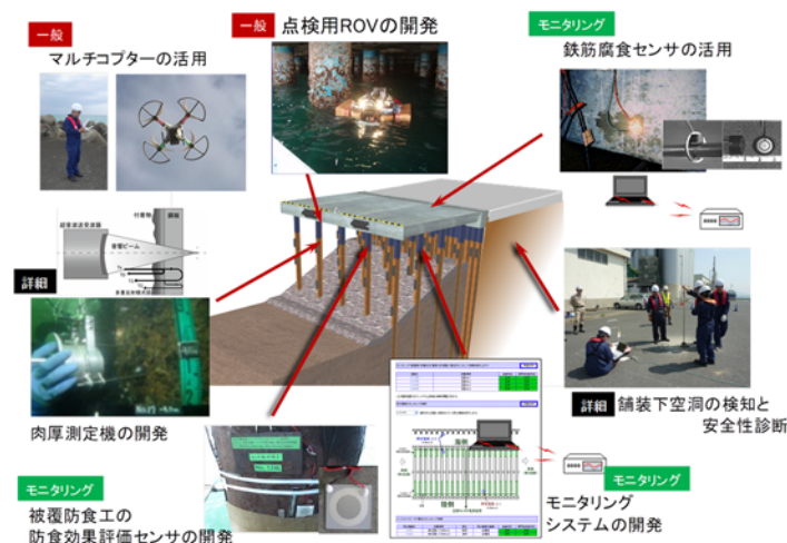
図 1.3.B38 棧橋の点検診断システム
