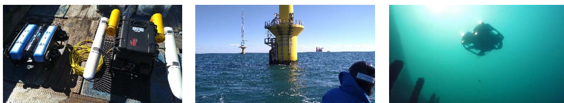
図 1.2.131 銚子沖洋上風力発電設備での海中部点検技術試験の様子 (AUV-ASV 連結システム(左)、風車塔に接近した ASV を作業船から撮影(中)、海底付近の AUV(右))
