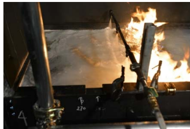
図 1.3.D25 分散消火実験
