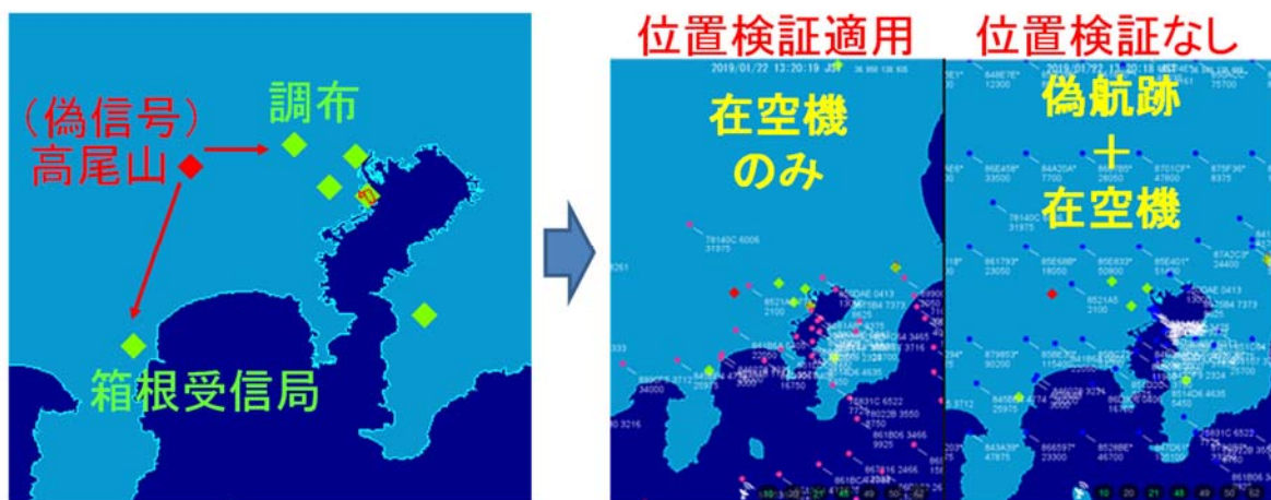
図 1.4.46 TDOA による ADS-B 位置検証の試験結果（表示画面）
