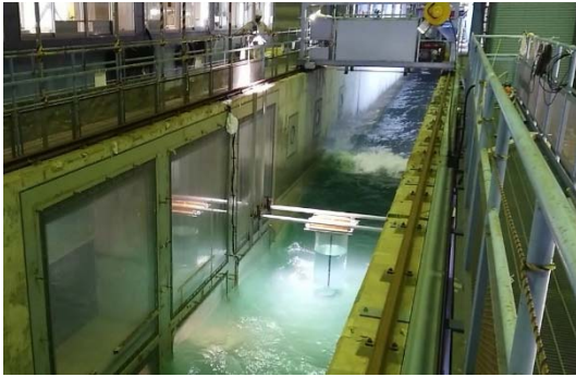
図 1.3.C32 洗掘防止工に関する大型模型実験
