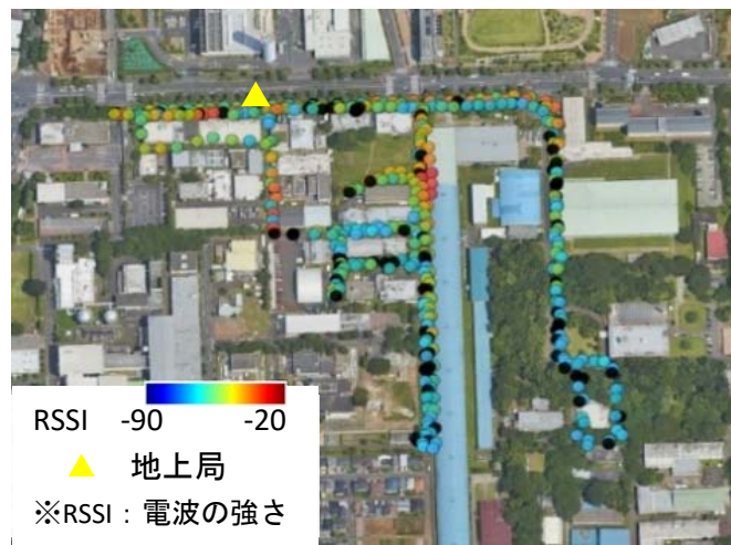
図 1.4.70 車両搭載通信実験結果 (RSSI は電波の強さ。赤色ほど強)
