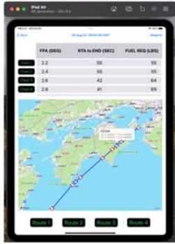
図 1.4.22 EFB 模擬アプリの表示画面 (降下経路の可視化機能及び 性能評価の数値)
