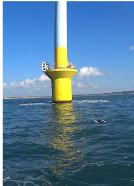
図 1.2.127 銚子沖洋上風力発電設備での「AUV-ASV 連結システム」による点検技術試験 ASV 単体による風車塔の自律周回航行の経路(左)とその時の様子(右)
