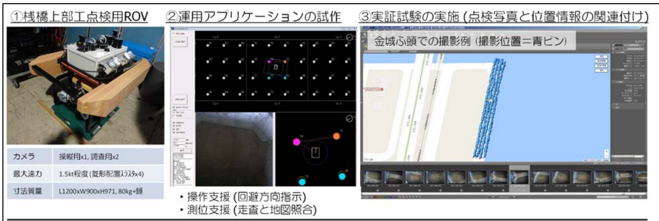
図 1.3.B37 棧橋上部工点検用 ROV(左)と運用アプリケーション(中)および実証試験結果(右)
