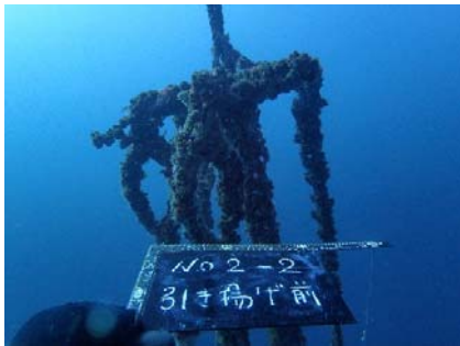
図 1.2.90 合成繊維索係留の観察例及び強度評価試験の様子
