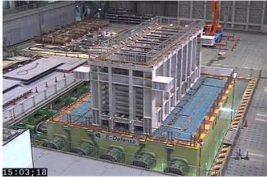
図 1.3.A31 大型振動台「E-ディフェンス」
