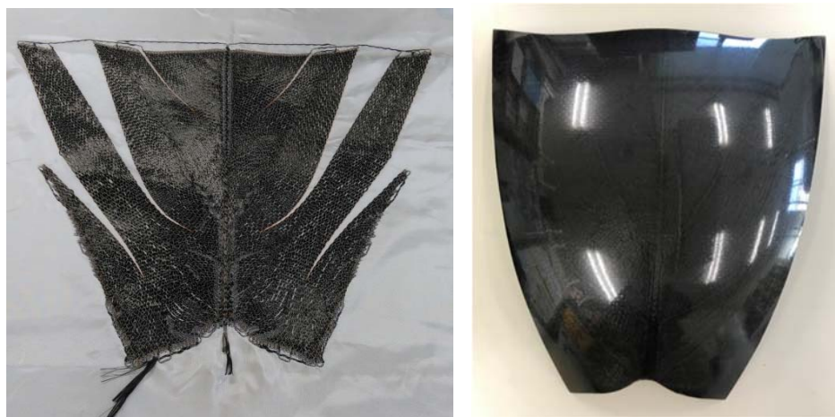
図 1.2.135 自動車ボンネット曲面に対する提案手法での CFRP 成形物
