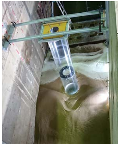
図 1.3.C28 洋上風力発電施設周囲の洗掘に関する大規模移動床実験
