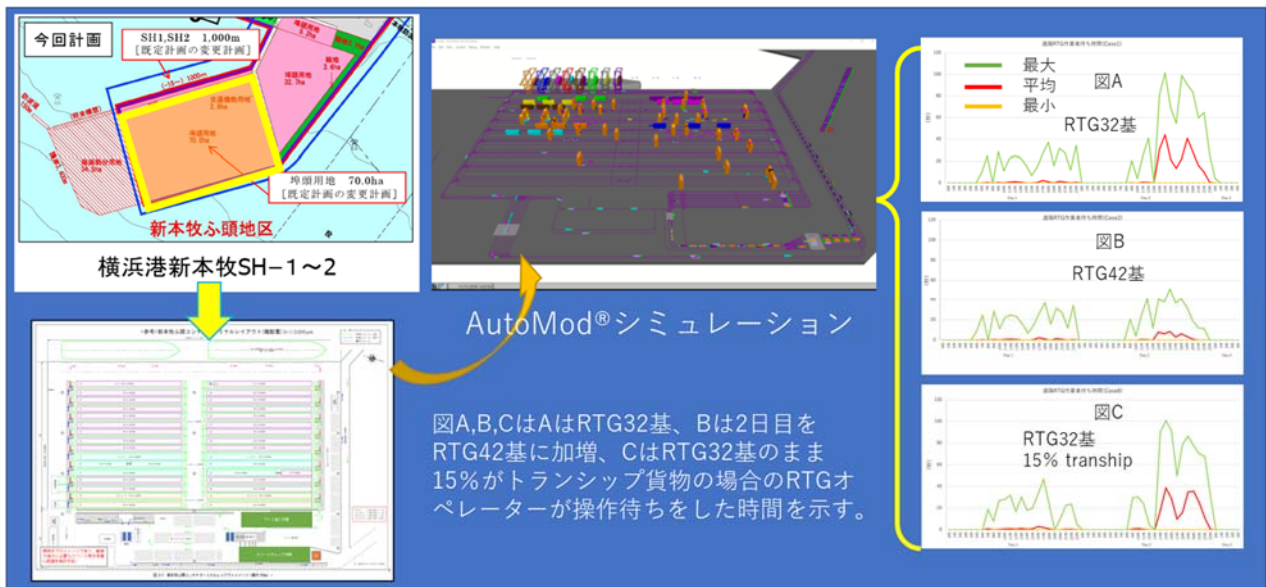
図 1.3.B17 2 日目に RTG を加増する例、15%がトランシップで内航船にシフトした例の比較評価
