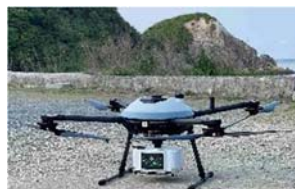
図 1.3.C13 グリーンレーザータ載ハイブリッド型ドローン メーカー側で、ガソリン燃料発電機よりバッテリーに給電可能としたハイブリッド型ドローンを開発、長時間飛行による測量、空撮が可能となった。
