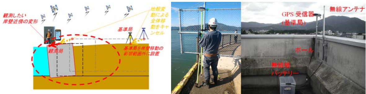
図 1.3.A4 RTK-GNSS を用いた岸壁変形量計測ツールと敦賀港における試計測
