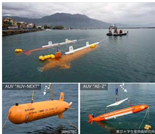
図 1.5.13 母船レス海底調査を可能とする洋上・海中ロボットシステム
