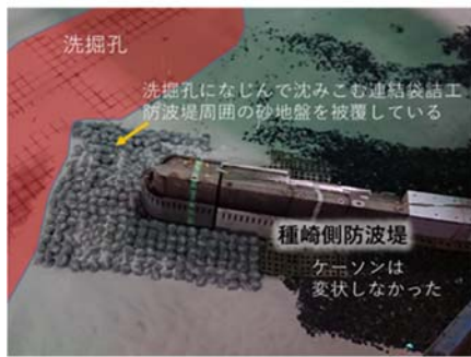
図 1.3.A62 袋詰め被覆工による洗掘対策
