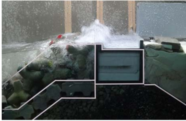
図 1.3.A105 ダブルパラペット+消波ブロックの越波実験
