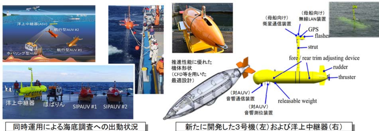
同時運用による海底調査への出動状況 新たに開発した3号機(左)および洋上中継器(右) (次世代海洋資源調査技術シンポジウム(2016.12.19)「無人探査機(AUV)の複数同時運用による海洋調査の新たなパラダイム」)
