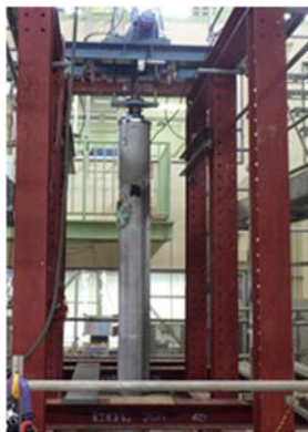
図 1.3.C30 大口径杭の水平載荷実験
