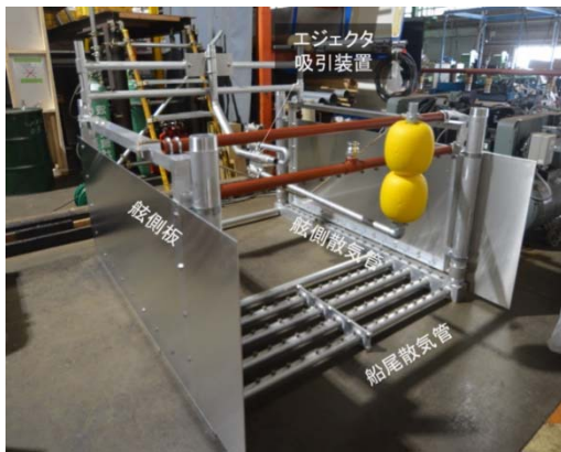
図 1.3.D29 次世代型油回収機実験模型
