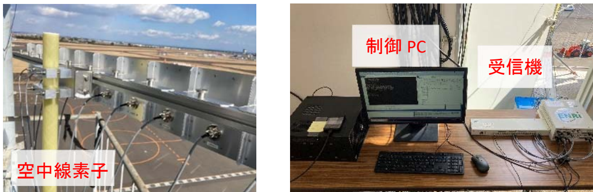
図 1.4.52. 素子と指向性制御方式の接続評価実験
