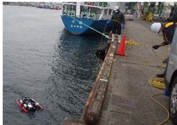
図 1.3.B46 点検用 ROV による栈橋下面調査の実施(大阪港大正地区)
