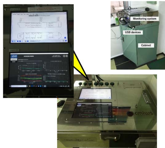
図 1.2.23 実船に搭載したデジタルツイン統合システム(i-SAS)
