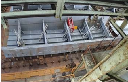
図 1.2.140 小組立および中組立本溶接工程の再現
