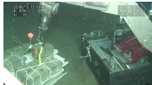
図 1.3.C40 深海(約 3515m)における部材接合実験
