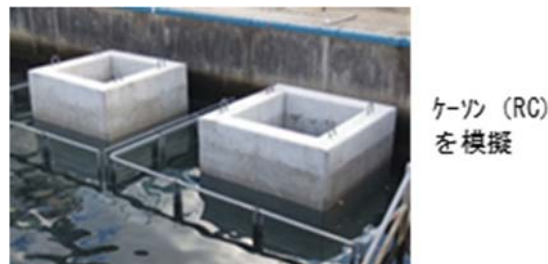
図 1.3.B28 高密度リサイクル骨材(銅スラグ細骨材)を用いたコンクリートの暴露試験(R2.12 開始) (実機プラントで製造しポンプ圧送で打設)
