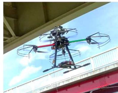
▲橋梁の損傷写真を撮影する技術
