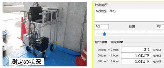
中性子をコンクリート表面から照射し、構造物に内在する塩化物イオン濃度を測定
