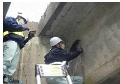
音響信号による打音検査でPCグラウトの充填状態を把握
