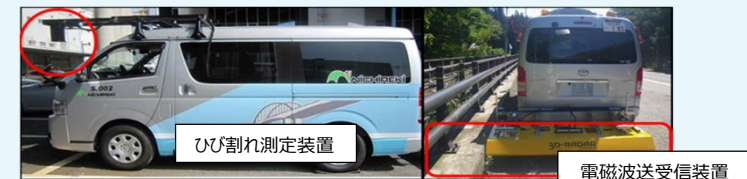
床版かぶり厚の推定が可能なレーダー探査車
