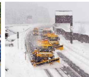
除雪作業状況
