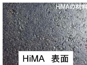
従来の材料と比較して、骨材の最大粒径が小さく、空隙率が小さい
