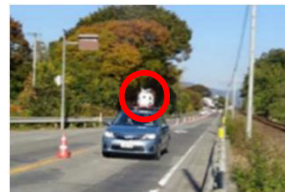
車載装置による路面性状測定
