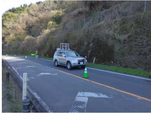
MMS※1を活用した点検技術
