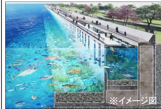
【生物共生型港湾構造物の整備】
