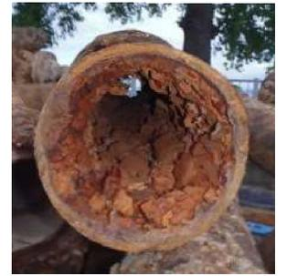
錆による水道管の腐食
