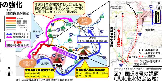
図7 国道5号の課題(洪水浸水想定区域)
