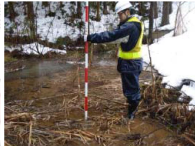
P4 法尻付近 下り車線側 (排水溜まりとなっている 旧水田は湿地状)
