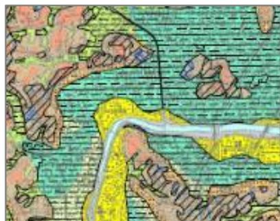
人工改変地、低地、自然堤防などの地形分類から地盤の硬軟（地震動の地盤増幅率）を推計
