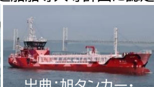
出典: 旭タンカー・HP フルバッテリー推進タンカー「あさひ」
