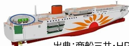
出典: 商船三井・HP LNG燃料フェリー「さんふらわあくれない」
