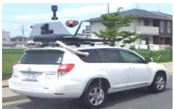
車載写真レーザ測量(MMS)
