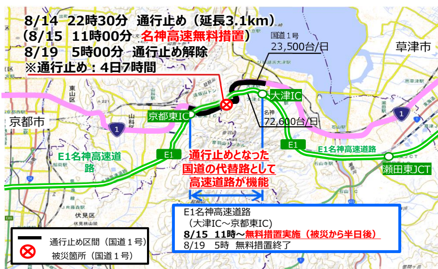
【国道1号被災状況（土砂流入：4日7時間通行止）】
