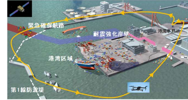
ドローン・衛星等を活用した施設点検
