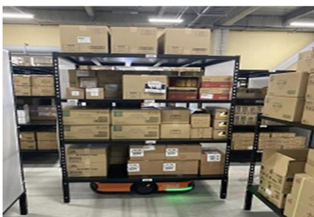
【AGV(無人搬送車)による貨物の運搬】
