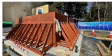
止水性検証水槽と外壁試験体
