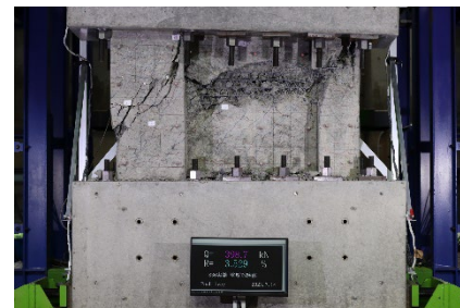
厚型壁試験体における試験結果
