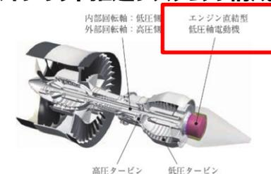
電動ハイブリッド推進システムの電動機のイメージ
