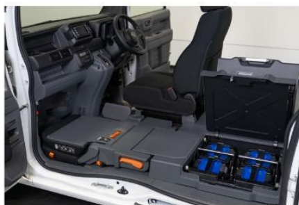
交換式バッテリーを搭載した車内
