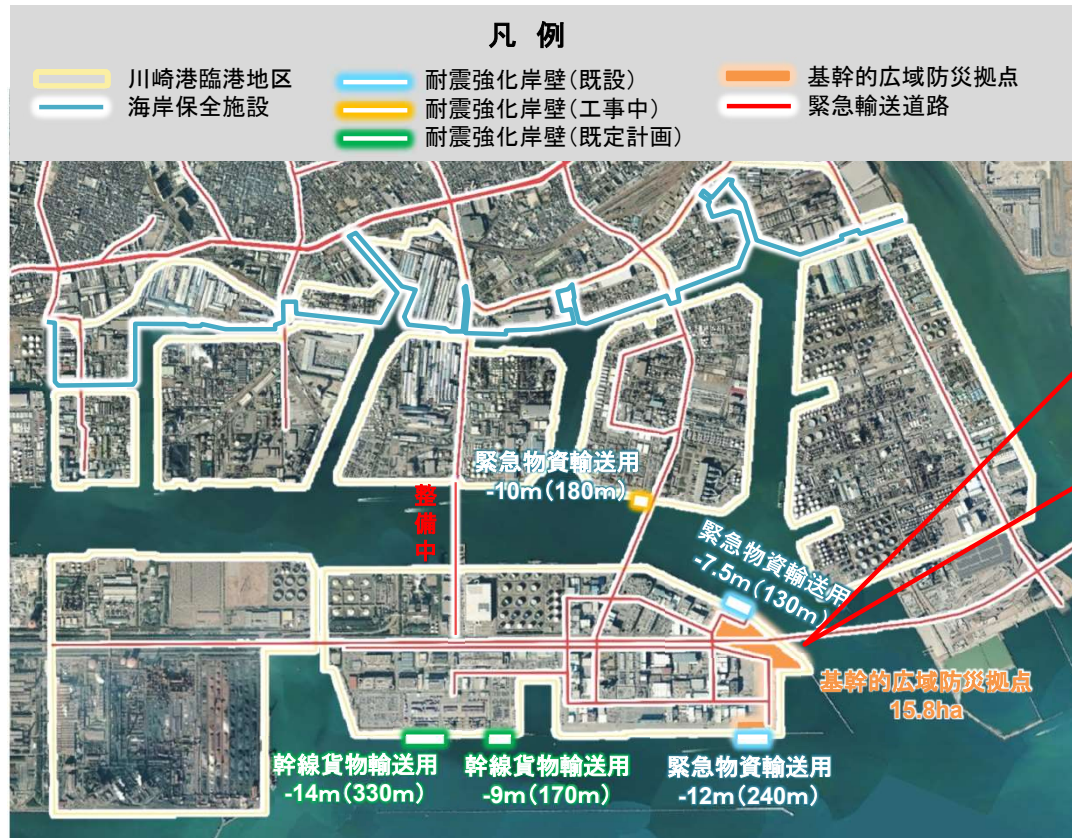
耐震強化岸壁・緊急輸送道路等配置図
