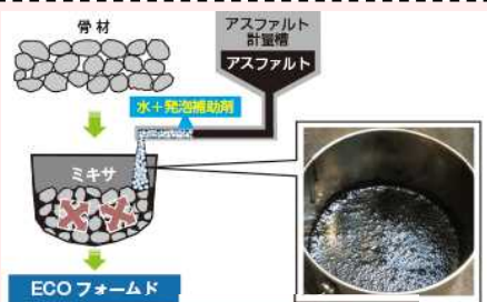
アスファルトの中温化技術
