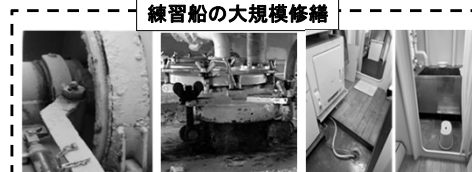
揚錨機の腐食 ・電装品の劣化
