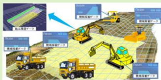
建設機械施工の自動化
