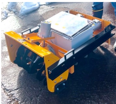
①－１ 屋根に乗せて遠隔操作で除雪する ロボットを研究（写真は除雪時の 雪の抵抗度を測るための試作機）
