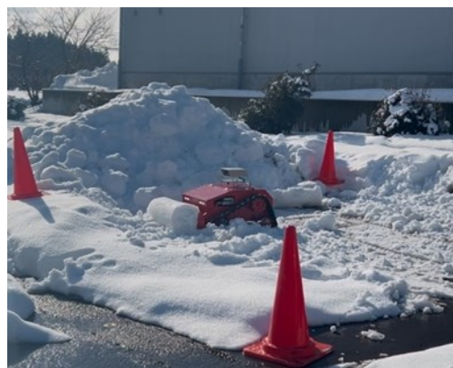
①－２ 平地の決められた範囲を 無人で自動的に除雪する ロボットの試作機
