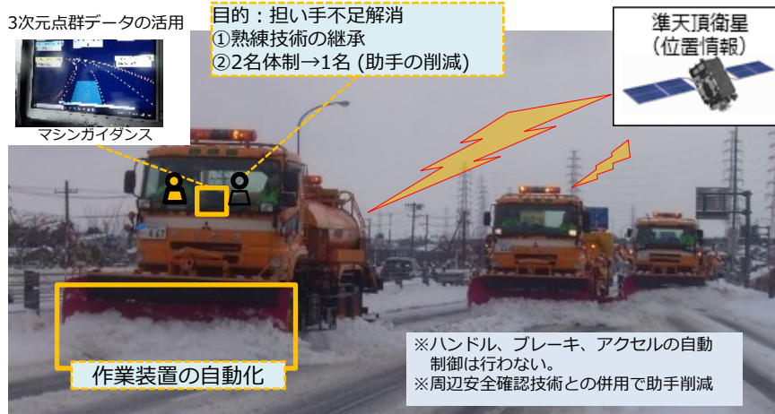
除雪トラックによる除雪作業の自動化イメージ
