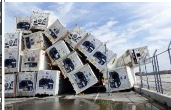
倒壊した空コンテナ（横浜港）
