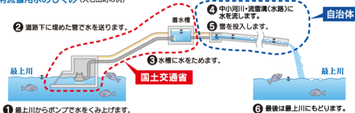
消流雪用水のしくみ（大石田町の例）
