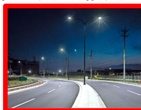
LED照明 (消費電力約56%削減)
