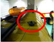
【車外】衛星測位アンテナ
