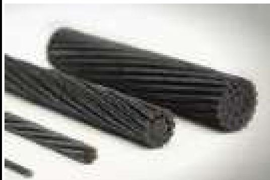
炭素繊維強化プラスチック(CFRP)
