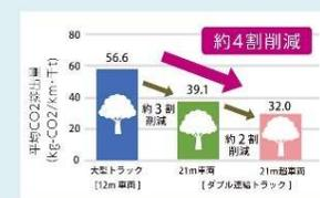
ダブル連結トラックによるCO<sub>2</sub>削減効果 (千トン・km当たりの排出量)
