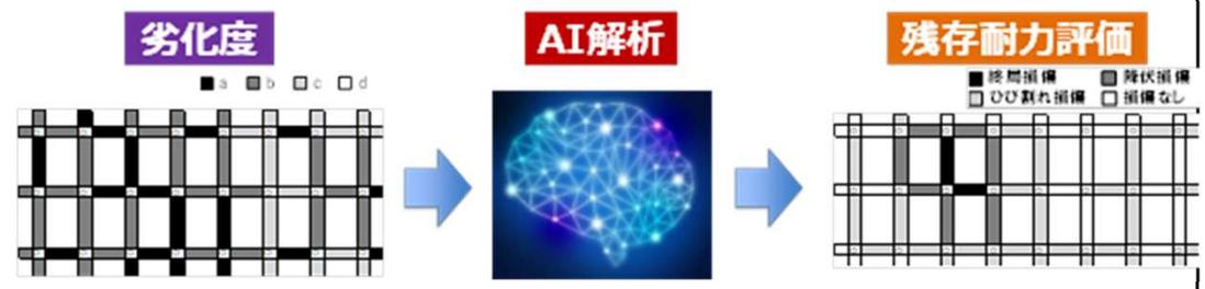
AIを活用して劣化度(目視による点検結果)から残存性能を評価する技術
