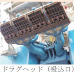
ドラグヘッド(吸込口)で土砂を吸込む ※ドラグは「引きずる」の意
