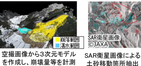
空撮画像から3次元モデルを作成し、崩壊量等を計測
