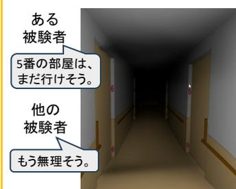
図3 実大スケールVR実験での廊下での煙の様子
