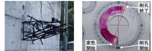
写真1 ドローンによる外壁面の中性化測定状況とその結果
