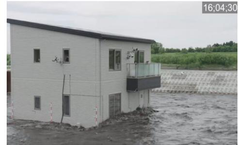
図1 十勝川千代田実験水路を活用した実大木造住宅の水理実験
