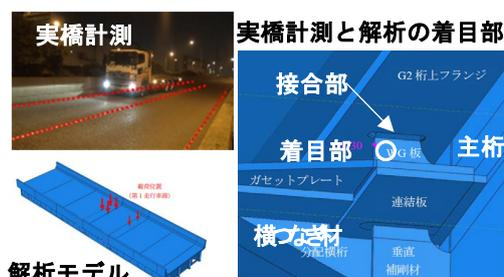
図-2 実橋計測と再現解析の着目部
