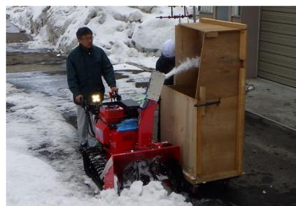
排雪重量計測試験状況
