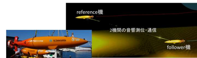
複数AUV協調群制御 実海域試験 (2機航行型AUV)
