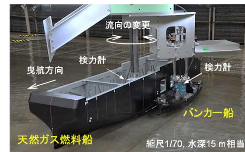
LNGバンカリング安全性評価に資する2船体拘束曳航試験
