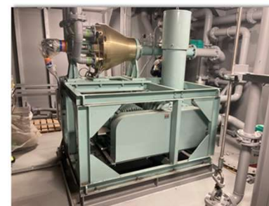
空気潤滑システム（ブロー、周期吹き出し装置）（左） と船底からの空気吹き出しイメージ（右）
