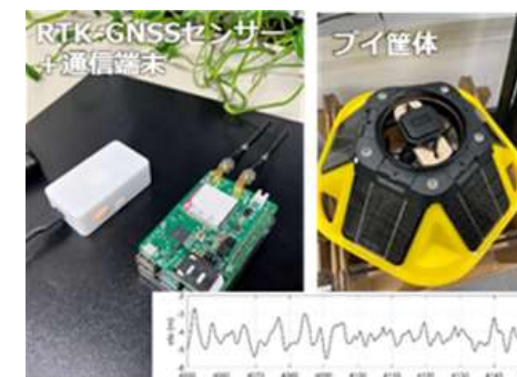
水位計測事例
