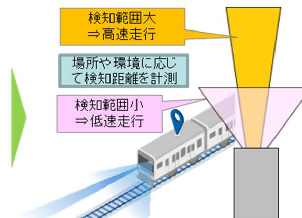
検知距離に応じた走行速度の制御
