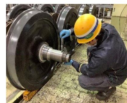
車両整備イメージ （輪軸検査作業）
