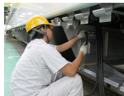
車両製造イメージ （配線配管作業）
