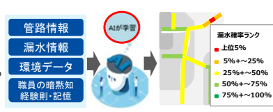
AIによる水道管の劣化度評価
