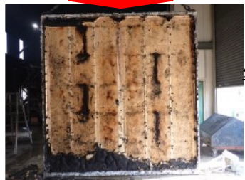
試験後解体した写真（内部の状況）
