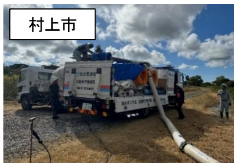
河川水のくみ上げ状況(排水ポンプ車)
